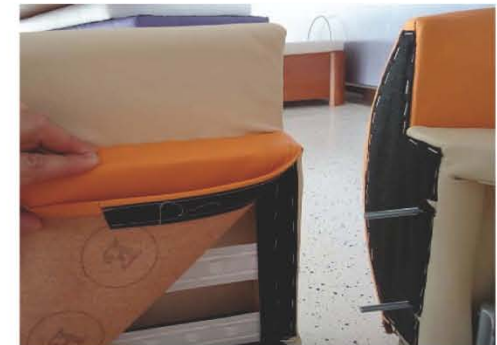
Detalle de una pata y el extremo de un larguero o travesaño visto por el interior antes de ser montada
