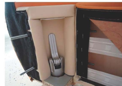
Detalle de una pata ya montada vista por el interior. En este caso se trata de una pata que incorpora la rueda de desplazamiento en la parte de los pies.
